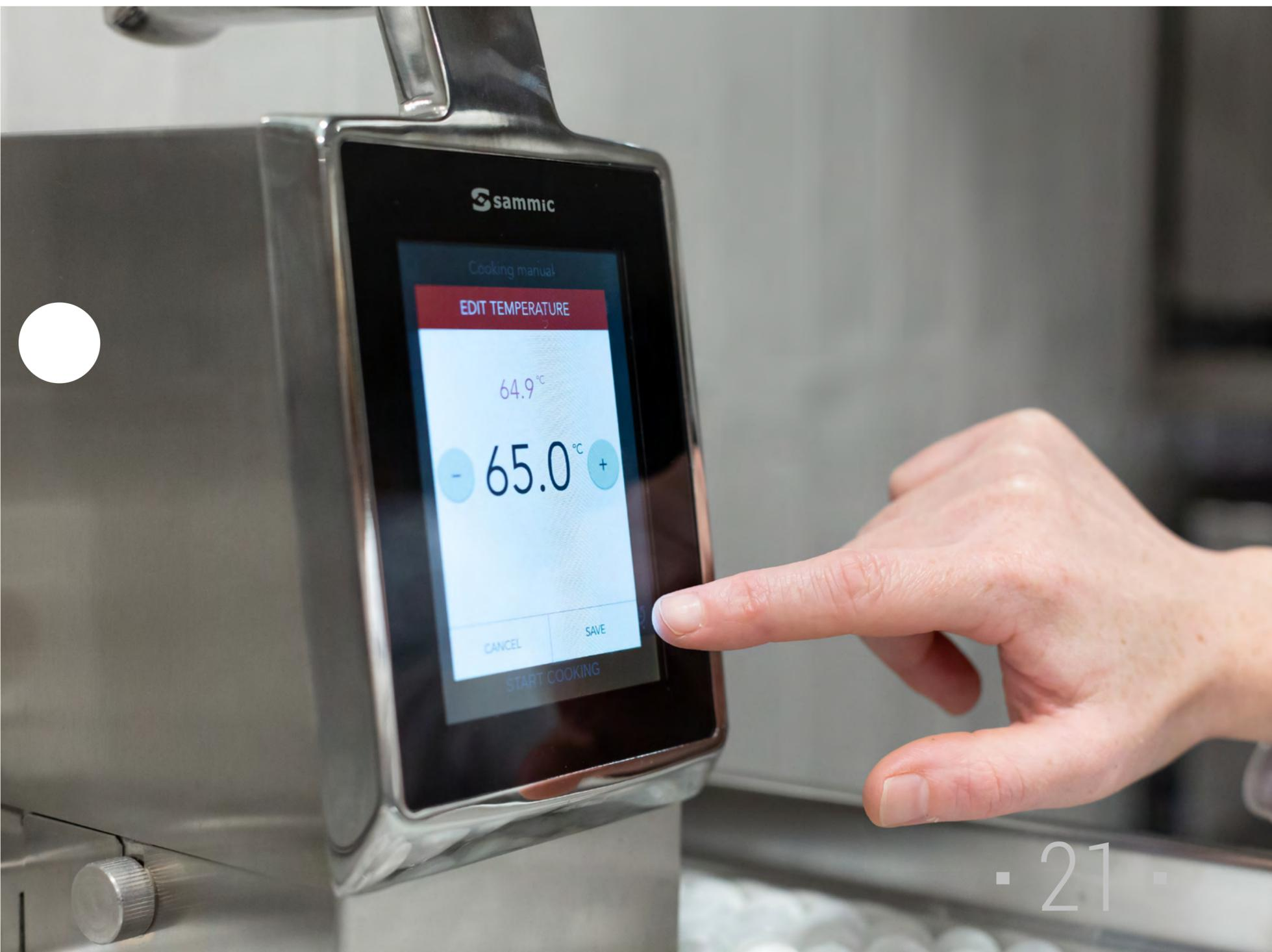
SmartVide X está equipado con una pantalla táctil a color de 5" de uso muy intuitivo especialmente diseñado para trabajar en cocina.
